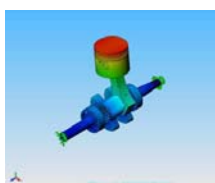
3次元CADを用いたエンジンの設計と振動解析
