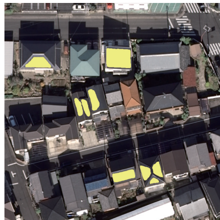
図 1. 春日井市内の建物の空中写真(左図)と、それを元に深層学習によって識別された太陽光パネル(右図・黄色いポリゴン)
