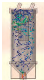
3次元CADで水の流れを解析
