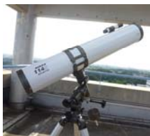
アルミ鏡を取付ける鏡筒
