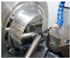
超精密加工技術により アルミ鏡を削りだす
