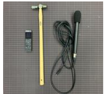
写真 4. 打音検査器具
