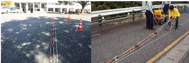
写真3 ランドストリーマー 写真4 牽引の様子
