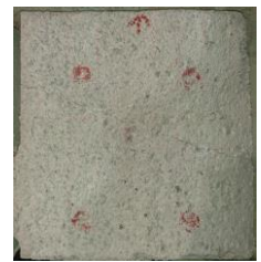
写真-2 ひび割れを導入した試験体
