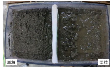
図7 液状化実験後の地表面
