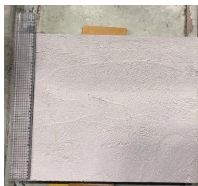
写真 2 1 辺 450 mm の試験体
