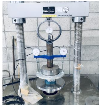
写真2 载荷試験装置
