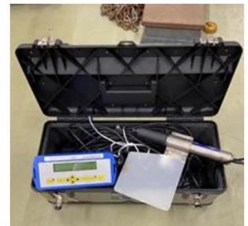
写真2 電磁流速計
