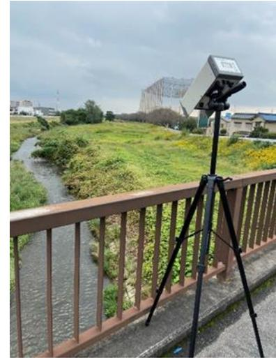
写真 5 電波流速計観測の様子
