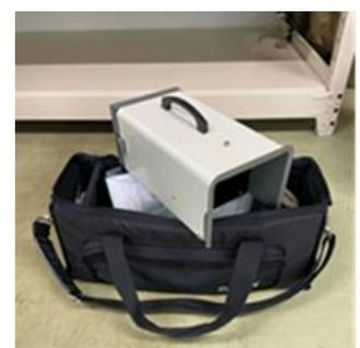
写真3 電波流速計
