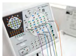
▲脳波測定に用いる電極。神経・精神疾患やてんかんの診断、脳の機能評価に用いる
