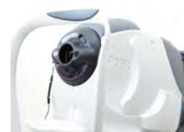
▲眼底カメラ。赤外光を照射し撮影する。網膜剥離や眼底出血、緑内障の診断に有用
