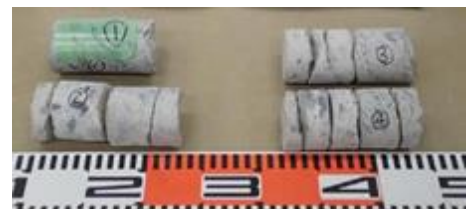
写真1 ひび割れ状況 1)
