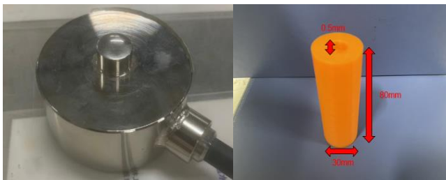
写真 5 荷重計 写真 6 凹凸に合わせた杭
