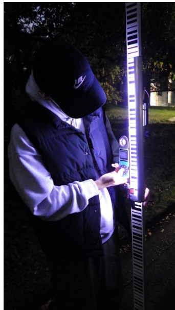
図1 夜間における電子レベルを用いた観測の様子
