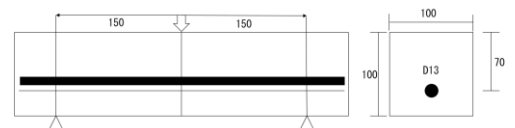
図-1 実験供試体概要
