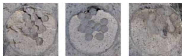
図-1 シース管内の PC 鋼材分布例 3)
