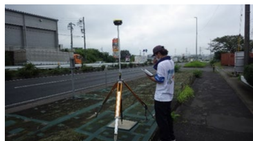
写真 2 基準点における観測の様子
