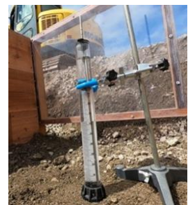
図 2-2 負圧浸入計による現場透水試験
