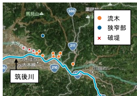
図2 災害発生箇所 2)
