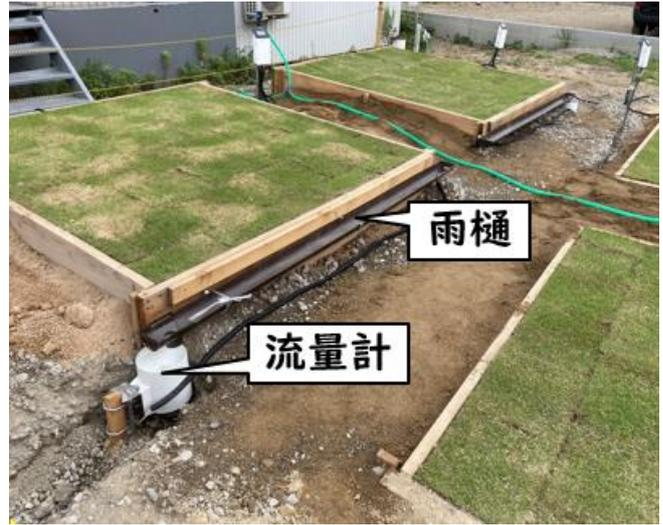
図 2.2.1 現場流出試験装置の様子
