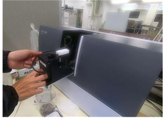
写真 2 レーザー回折式粒子粒径測定装置
