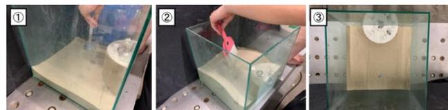
図 3.3 動的コーン貫入試験地盤作成方法
