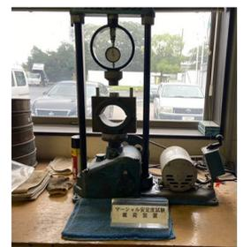
写真1 供試体 写真2 マーシャル試験器具
