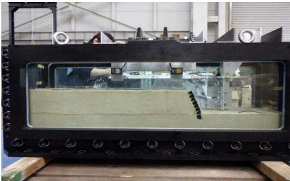
写真-2 遠心実験模型
