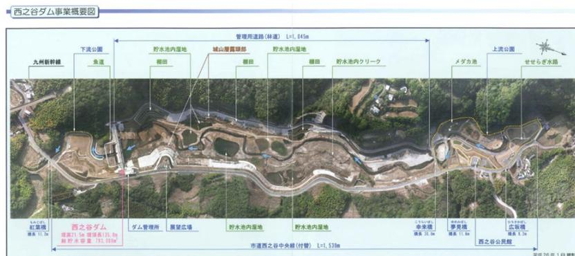
西之谷ダムは従来の田園風景や自然環境が損なわれてしまう可能性があることから、平常時は自然河川と変わらない流水型ダムの特徴を生かし、自然環境に与える影響を減らすために貯水池全体を湿地として再生している。貯水池内の整備として貯水池内底面には、素掘りの湿地、クリーク、棚田等が造られており、多様な生物が生息する湿地環境が成り立っている。湿地帯の植生であったり、人工的に造られた棚田等が大規模な降水の際に土砂の移動を阻害してしまう可能性があるのではないかとされる。
