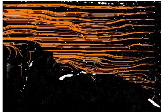
図 3.4 角礫のときの流線
