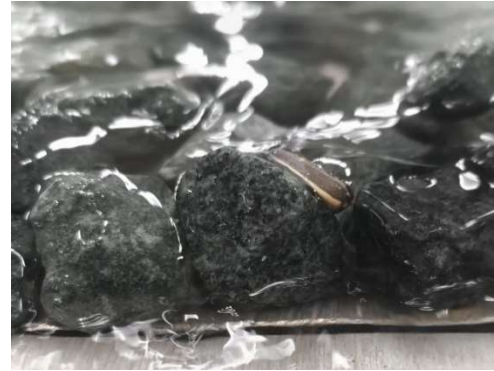
図 3.2 礫に引っ掛かり，堆積する様子
