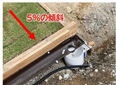
写真1 雨樋による表面流出量の計測
