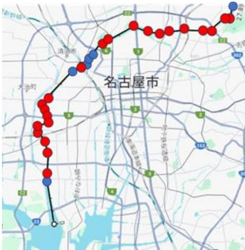
図6 AIによる左岸亀裂の有無予測の地図
