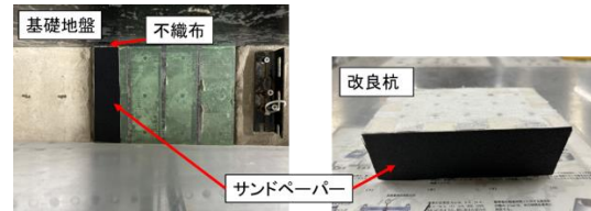
写真-5 改良杭の固定方法
