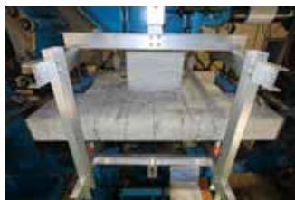
厚肉床壁構造接合部の構造実験
