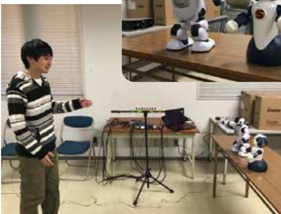
マイクロホンアレイを用いた ハンズフリーロボット音声対話システム
