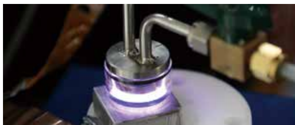
本研究室が持つプラズマプロセス装置の1つ（容量性結合プラズマ）
