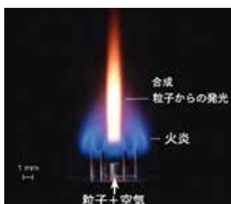
微小拡散火炎群による機能性微粒子の火炎合成
