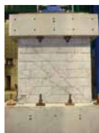
鉄筋コンクリート組積造耐力壁の構造実験
