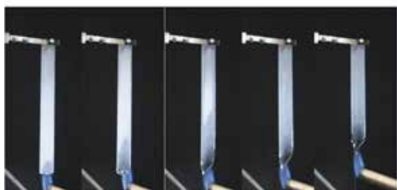
分子量の異なるポリエチレンのUL 燃焼試験 上：高分子量のポリエチレン（射出成形グレード） 下：低分子量のポリエチレン
