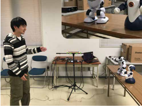
マイクロホンアレイを用いた ハンズフリーロボット音声対話システム
