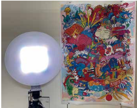
概日リズムをコントロールするスマート照明
