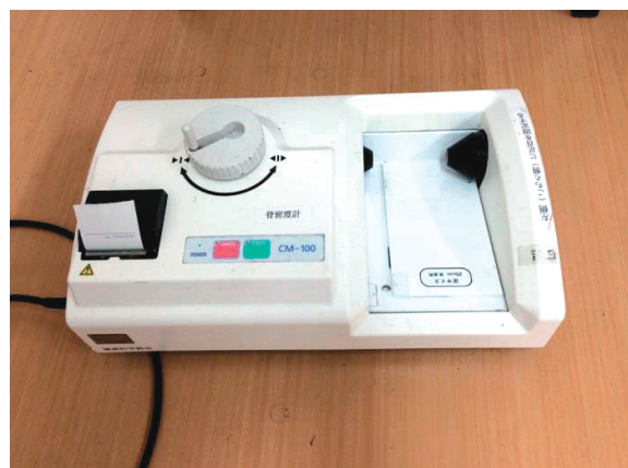
写真2 超音波骨密度測定装置CM-100
