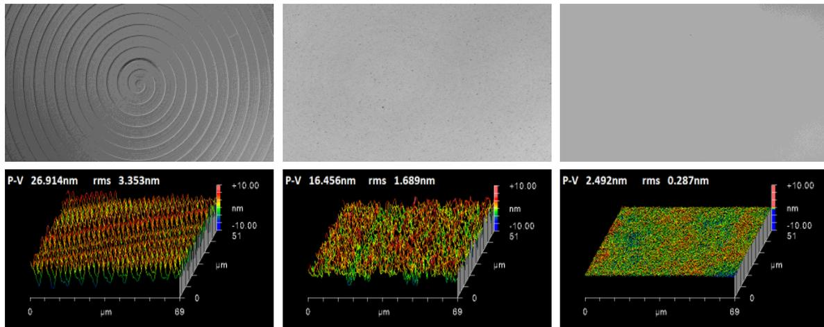
图 11 表面纹理在金刚石车削（左）、流体射流抛光（中）和连续预加工抛光（右）后的表面纹理。
