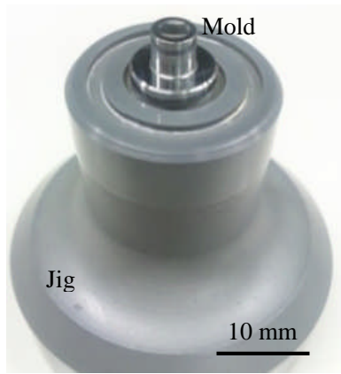
(a) 微粒子超合金製非球面金型外觀
