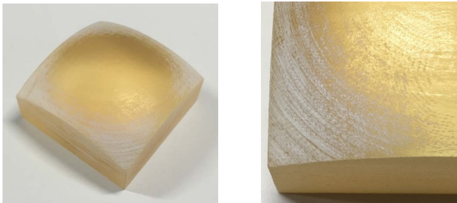
図 5 磨きの基礎データ収集のためのドーム形状モデルと拡大図
