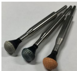
図3 SAG 工具（粒径 40\mu\text{m} ， 9\mu\text{m} ， 3\mu\text{m} ）
