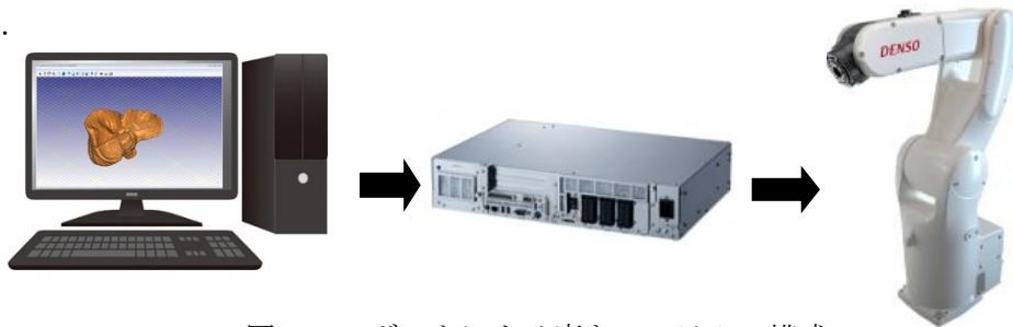
図2 ロボットによる磨きシステムの構成
