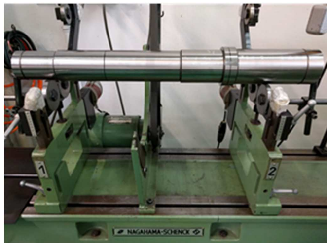
図6 釣り合い試験機 (株式会社長浜製作所製 NAGAHAMA-SCHENCK H20B) に搭載したテストピースの外観
