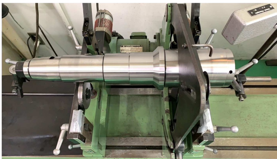
図2 釣合い試験機（株式会社長浜製作所製 NAGAHAMA -SCHENCK H20B）にて動バランス測定中のスピンドルシャフト
