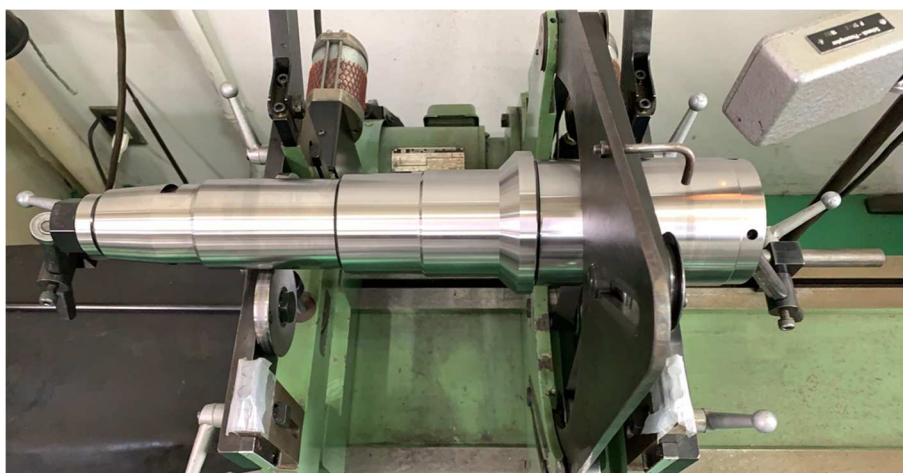
図3 釣合い試験機（株式会社長浜製作所製 NAGAHAMA -SCHENCK H20B）にて動バランス測定中のスピンドルシャフト
