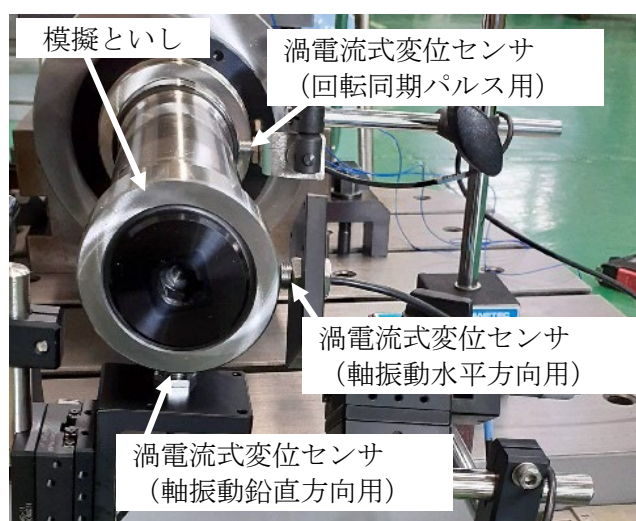
図3 ホイールアーバ先端の模擬といし部分での軸振動測定およびアーバ口元での回転同期パルス測定のための渦電流式変位センサ配置状況
