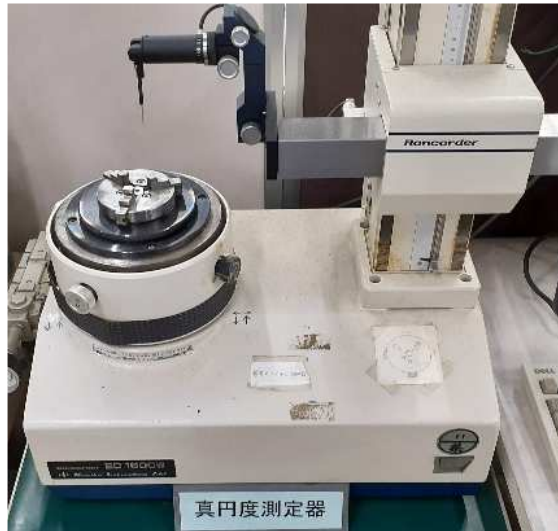
図7 模擬といしの外形真円度の測定状況
