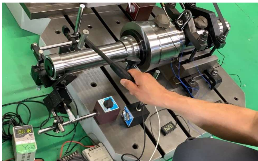
図1 試運転台上での試運転中に内面研削スピンドルの打撃試験
