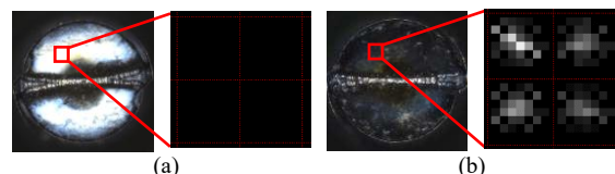
図 4 目詰り状態の違いによる HoG 特徴ベクトルの変化:(a) 目詰り領域における輝度変化が小さい場合の特徴ベクトル HoG, (b) 目詰りが軽微な場合に輝度変化が大きくなることで特徴ベクトルが大きくなる様子
