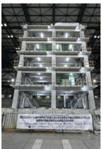
実大5層鉄筋コンクリート造建築物の振動台実験
