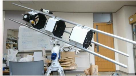
[伸縮式・焦点距離可変の自作鏡筒]
